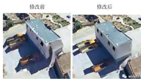
(d) 建筑墙体扭曲矫正
